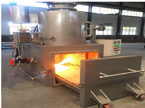
شکل ۲. زباله سوز معیاری برای زباله طبی با درجه حرارت ۱۰۰۰ درجه سانتی گراد.
